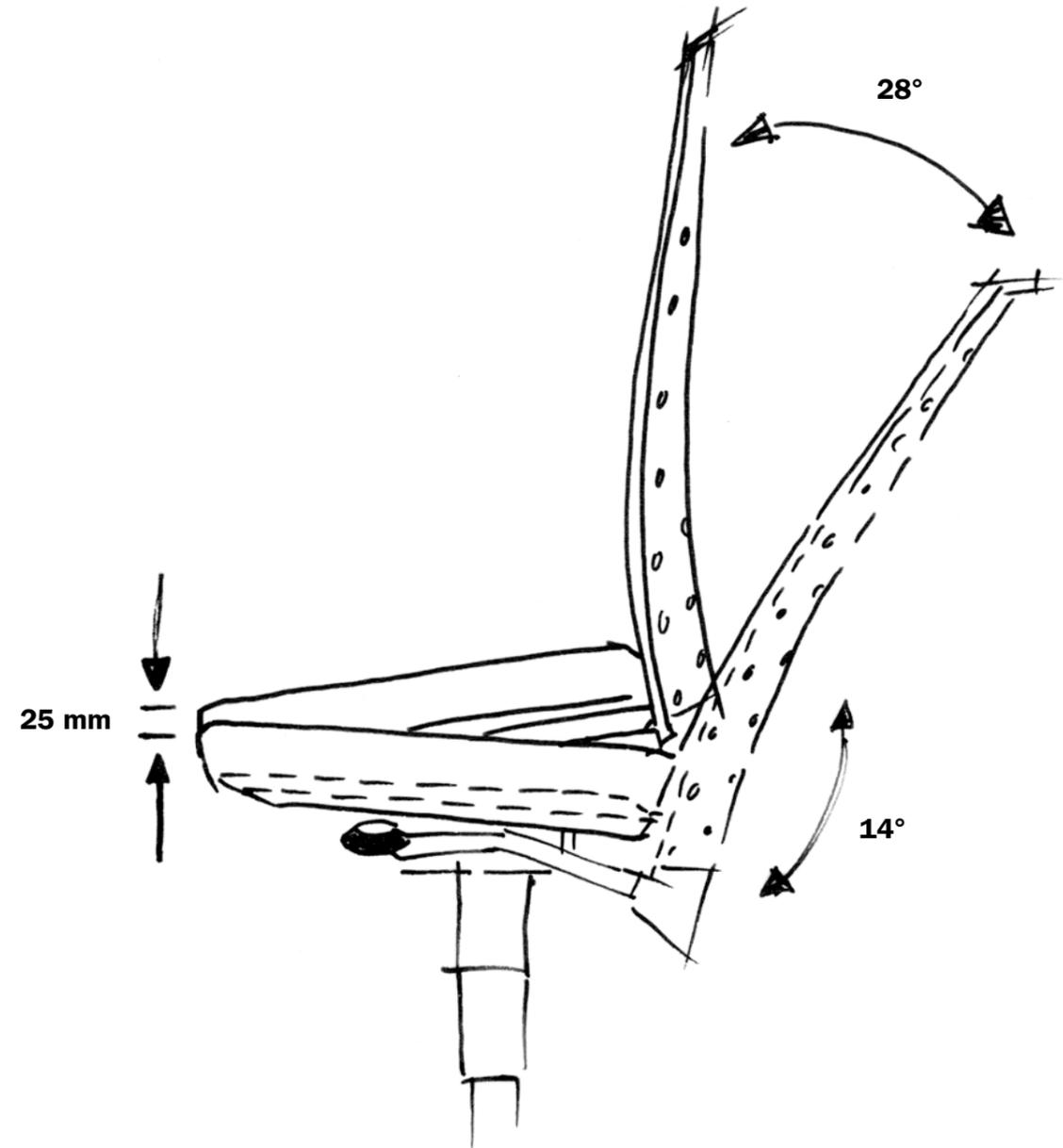
**Die Idee:** ein Bürostuhl, der den Körper in jeder Arbeitshaltung und bei jeder Bewegung unterstützt – und sich an jeden Nutzer anpasst. Die Umsetzung: ein echtes Bewegungswunder mit patentierter DTS-Synchronmechanik (Dynamisches Torsions-System), Lordosenstütze, individuellen Einstellmöglichkeiten und Multifunktionsarmlehnen. TENSA fördert gesundes Sitzen am Arbeitsplatz – und überzeugt durch das elegante Design von ITO.
